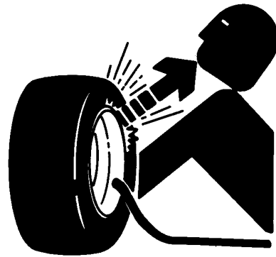
Взрывоопасно! Шина с неразборным ободом
